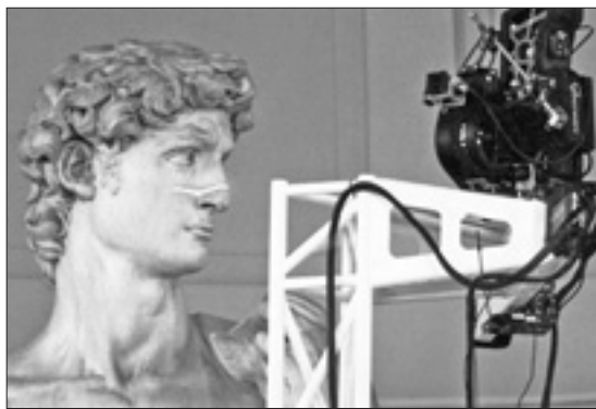
Scansione del volto del «David» per la ricostruzione tridimensionale computerizzata
